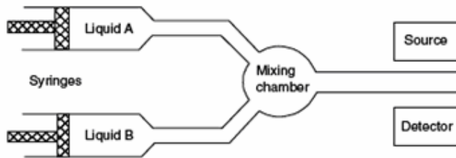
الشكل (٨-٤) يبيّن تمثيلاً لجهاز الجملة التدفقية المستمرة مع مصدر وكاشف الجهاز الطيفي.
